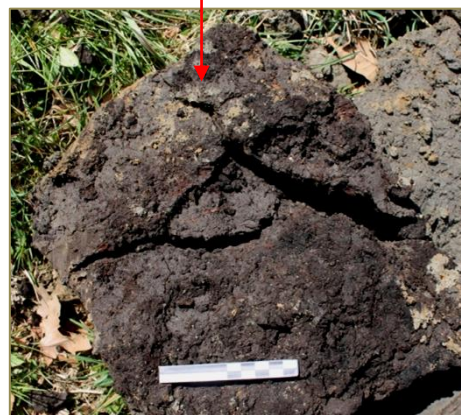
Figura 38: sul fondo del sondaggio SB1 sono presenti resti di piante (foto a sx). Particolare del deposito torboso (foto a dx). La sezione descritta è quella sud.
