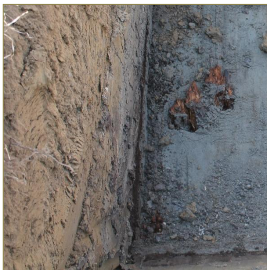
Figura 38: sul fondo del sondaggio SB1 sono presenti resti di piante (foto a sx). Particolare del deposito torboso (foto a dx). La sezione descritta è quella sud.
