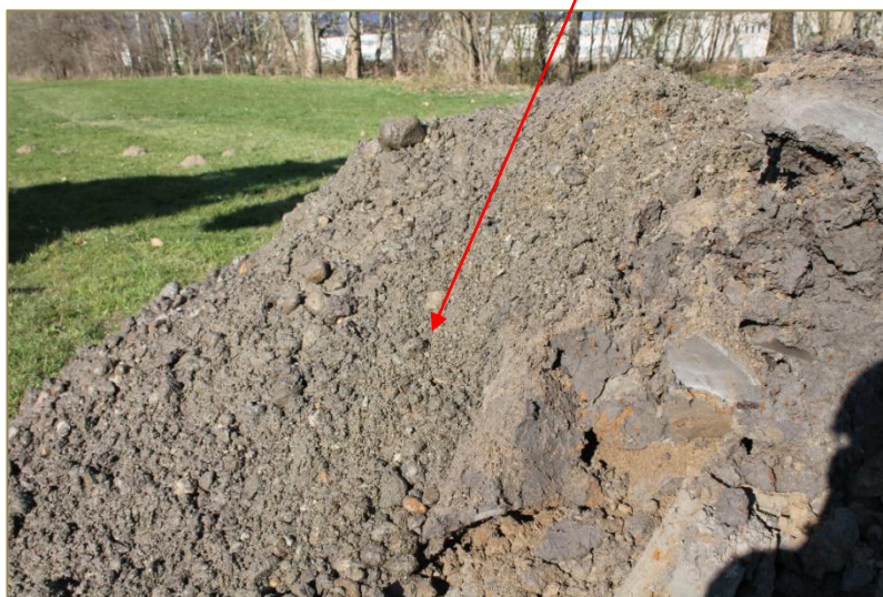
Figura 36: particolare del deposito ghiaioso presente sul fondo del sondaggio SA5. La sezione descritta è quella ovest.
